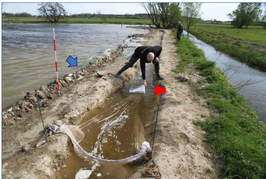
Foto 2. Yngelfælden (rød pil) monteres i afløbet ved stor vandføring den 30.4.2024. Bemærk at diget mod engen (blå pil) var blevet forstærket med lerholdig jord.
